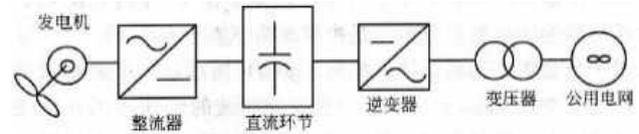
图1 AC-DC-AC风力发电系统示意图
