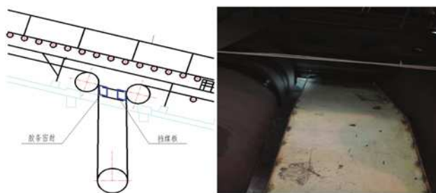
图6 带式输送机拉紧孔封闭装置
