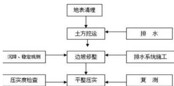
图 市政道路软土地基施工流程图
