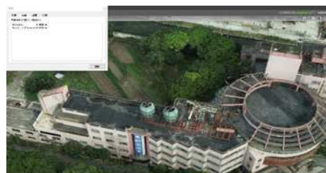
图 6: 利用三维倾斜模型获取建筑数据
