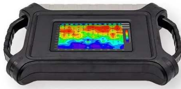
图 1 单通道 MT 电磁仪示意图
