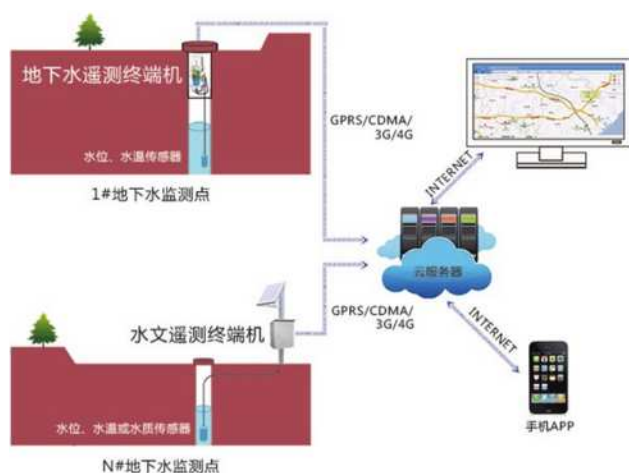
图1 地下水位监测系统
