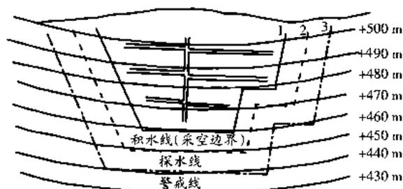
图1 积水线探水线和警戒线示意图
