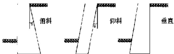
图3.2 重力式挡土墙图形
