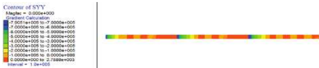
图3 软岩条件下锚固段注浆体轴向应力云图
