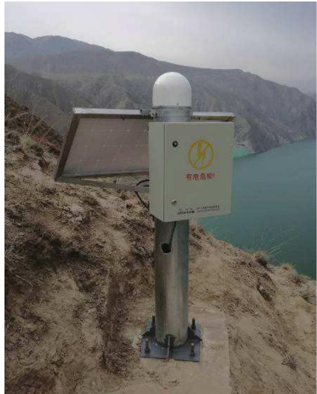
图 2：自动化检测系统设备
