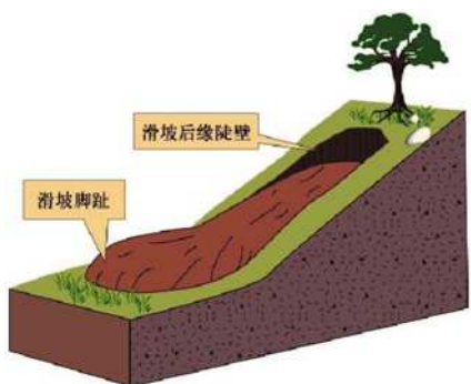
图2 土质滑坡示意图
