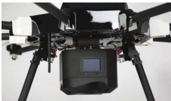
图一 无人机搭载倾斜照相设备
