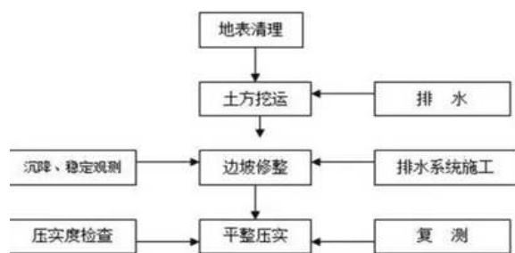
图 市政道路软土地基施工流程图
