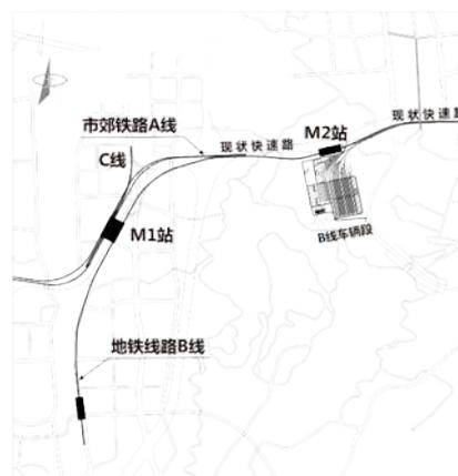
图1 A线与B线位置关系平面示意图
