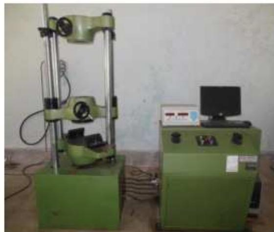
图4 通用测试机（型号-MECH/UTE-40T）
