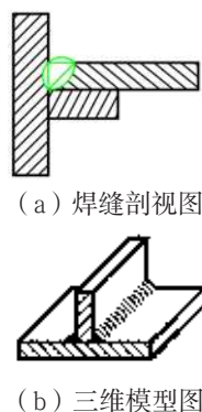
图1 T型焊缝结构示意图
