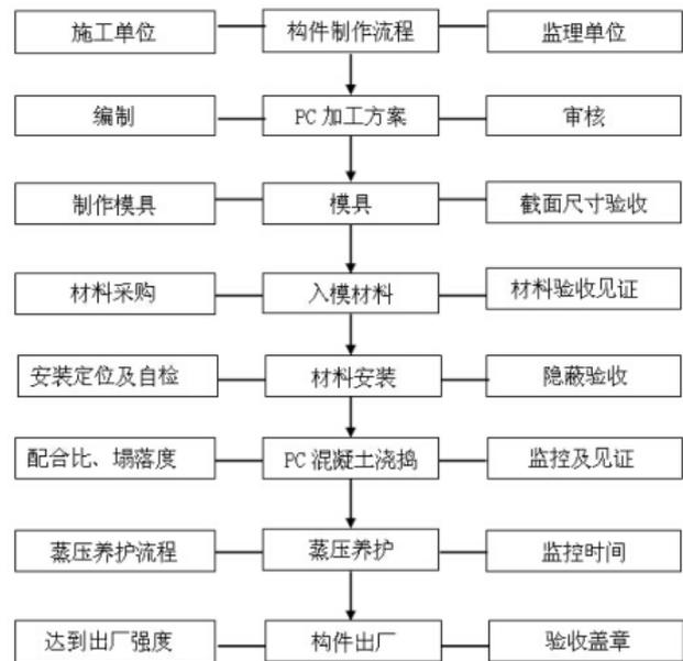
图3 PC构建制作监理工作流程图
