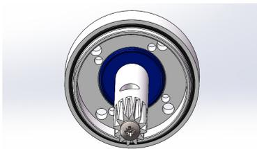
图2 齿套双层密封圈示意图
