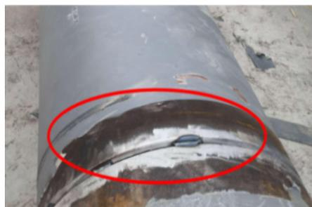
图1 根焊未完成50%撤离外对口器
