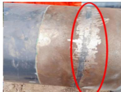
图2 单道焊接代替排焊
