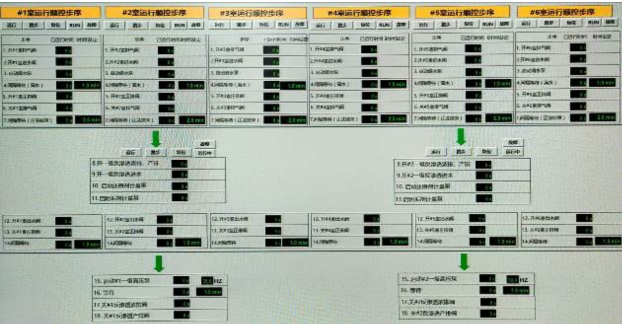
图三：砂滤、一级RO运行顺控步序图
