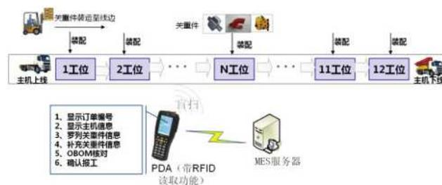
图3 基于RFID的信息采集方案
