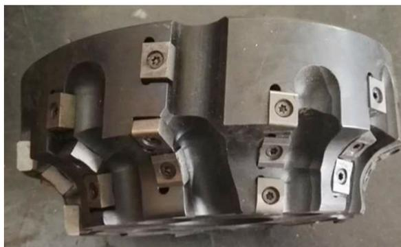
图2 心轨鱼尾空间铣削示意图和刀具
