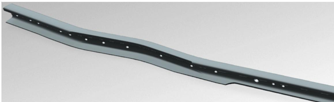
图3 翼轨弯折模型
