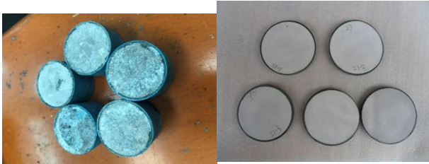
图4 受潮严重的阀片图5 正常的氧化锌阀片
