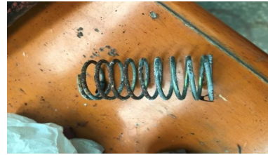
图 6 锈蚀的压紧弹簧
