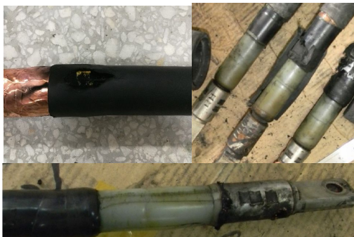
图3 含气隙缺陷的样品放电及击穿结果
