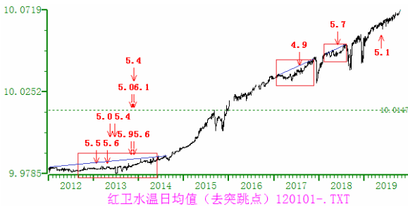
图3 2012年1月~2019年9月吉林松原地区5级以上地震前红卫井地下水水温变化曲线
