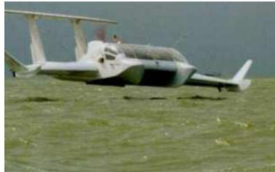
图2 “HW-2VT”地效气垫复合船
