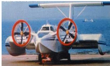
图3 “天翼”1型地效翼船
