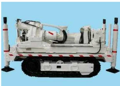
图1 煤矿工程的定向钻进设备
