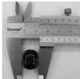
图7 封装完成的微存储器（15 mm）
