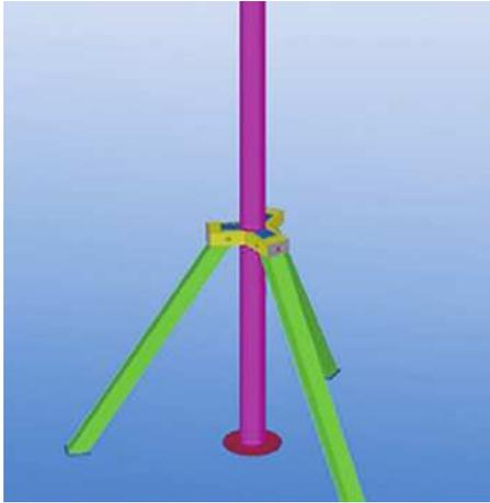
图 2 PC 叠合楼板支撑三脚架模型
