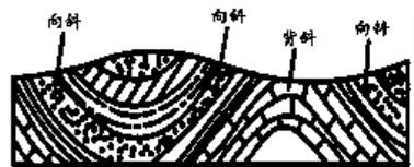
图1 矿井岩层的褶皱构造示意图
