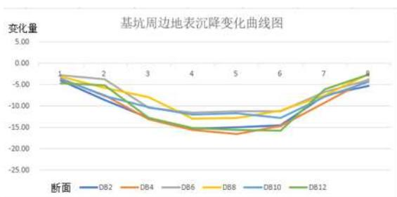
基坑开挖过程中，随着开挖深度的不断增加，坑外水位也不断下降，坑外土体产生侧移，向基坑内一侧移动，墙体水平位移变化量不断增大，加之基坑开挖过程中大型机械施工对土体反复碾压，导致地表沉降量数据较大。随着基坑底板浇筑完成且达到设计强度后，整个基坑属于箱涵结构，整个基坑周边土体达到稳定，且施工过程中大型施工机械数量减小，地表继续变化量减小，趋近于稳定状态。
