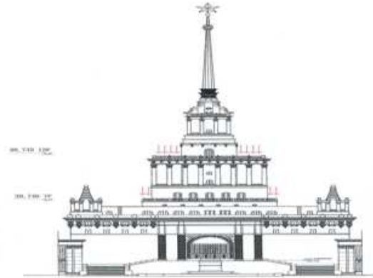
图6 钢塔倾斜监测点布置示意图
