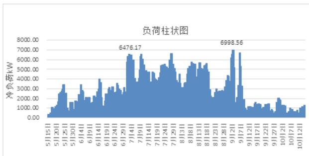
由计算结果可知,空调季冷负荷值发生在九月,最大冷负荷值为6998.56kW,不保证50h最大冷负荷为5552.37kW(出现在7月23日19点)。
