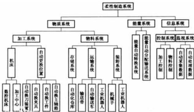
图1 柔性制造线的组成
