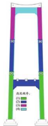
图2 塔柱及横梁浇筑顺序
