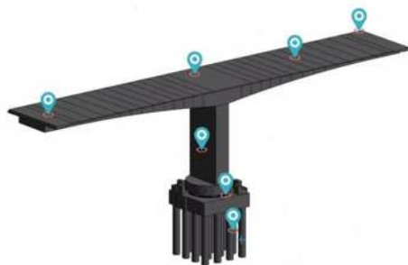
图2 转体球铰安装偏差分析模型
