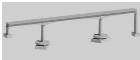
图3 转体合龙模拟分析模型
