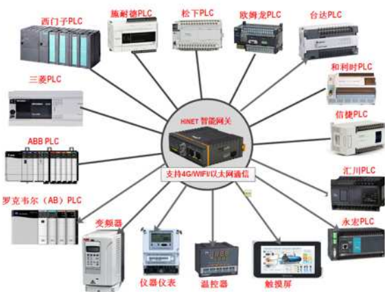
图3 电气工程自动化监控方案
