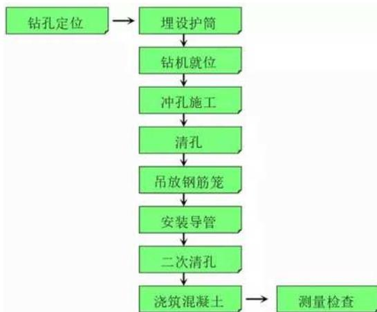
图1 灌注桩施工工艺流程
