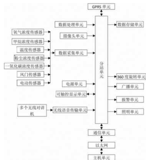
图1 某种煤矿安全监测监控系统分站单元构成
