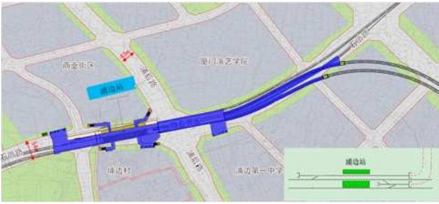
图3 一岛一侧方案平面图
