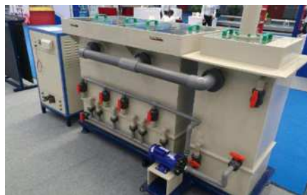
图二 污水电催化氧化装置
