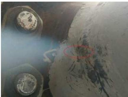
图1 管线法兰焊道裂纹
