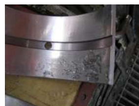
图1 大头瓦表面合金脱落
