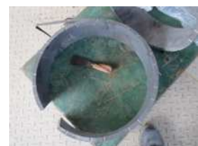
图4 支承环厚度四个月减薄2mm
