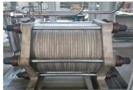
图3 QDQ2-1A型自动水电解制氢设备电解槽
