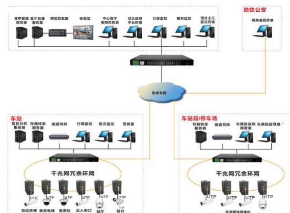
图 1 地铁通信视频监控系統流程
