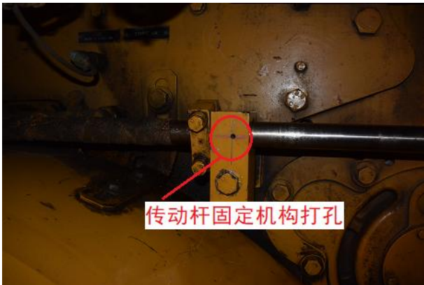
图 15 传动杆固定机构钻孔
