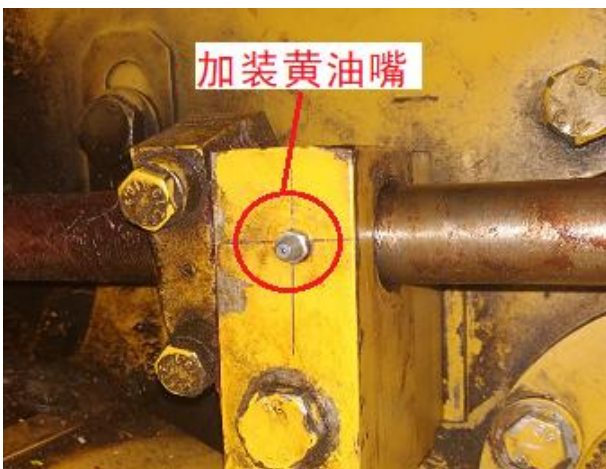
图 16 传动杆传动机构加装黄油嘴
