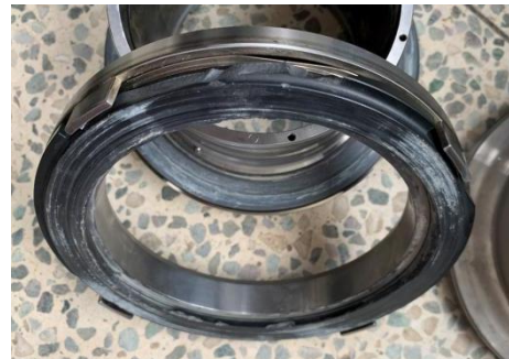
图2（摩擦副受损严重，不可复用）
