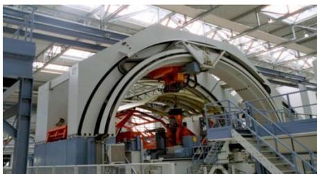
图2 A380机身壁板自动制孔系统
