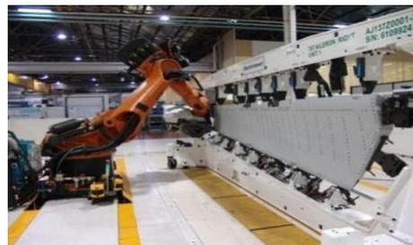
图4 B787襟副翼自动制孔
