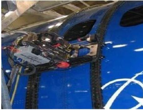
图5 柔性导轨自动制孔系统
