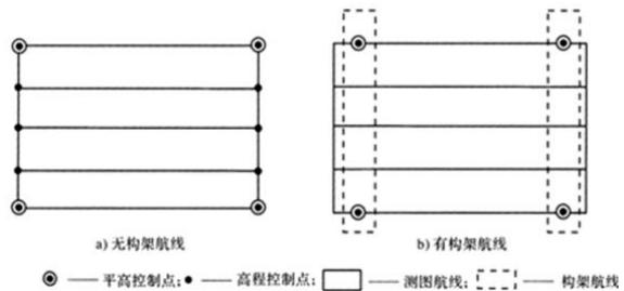
选择像控点位必须符合规范,选择清晰的地表建筑,带有阴影,重影较多的地状物尽量在选择目标之外。像控点测量完成要对成果进行检查,对野外控制像片、外业控制网布点略图、控制点成果进行检查;查看像控点在测区范围内、外的分布是否满足加密要求;查看控制片上点位刺点位置是否清晰,点位具有唯一性,是否达到 6 片或 5 片重叠,与像主点和像片边
