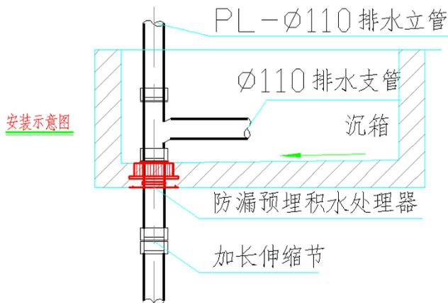
图3 安装示意图
